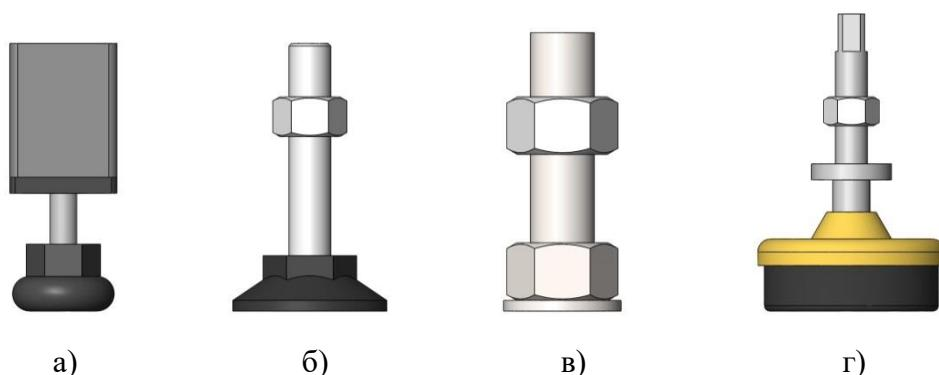
Рисунок – 17. Виды опор, применяемые при изготовлении блоков «БРАНТ»: а) – М10 при массе блока до 500кг, б) – М16 при массе блоков 500...2000 кг, в) – М24 при массе блоков выше 2000 кг, г) - виброизолированная опора
