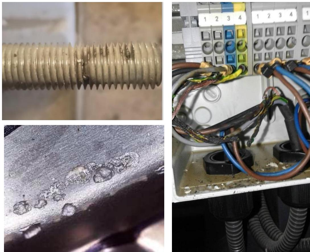
Рисунок – 22. Последствия неправильного подключения «массы» сварочного аппарата
