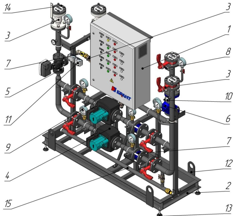
Рисунок – 41. Основное оборудование БТП-32: 1 – шкаф управления, 2 – рама блока, 3 – запорная арматура, 4 – насос, 5 – клапан регулирующий, 6 – фильтр, 7 – клапан обратный, 8 – термопреобразователь, 9 – манометр, 10 – термометр, 11 – реле давления, 12 – строповочная проушина, 13 – регулируемая опора, 14 – ответный фланец, 15 – дренажный коллектор.
