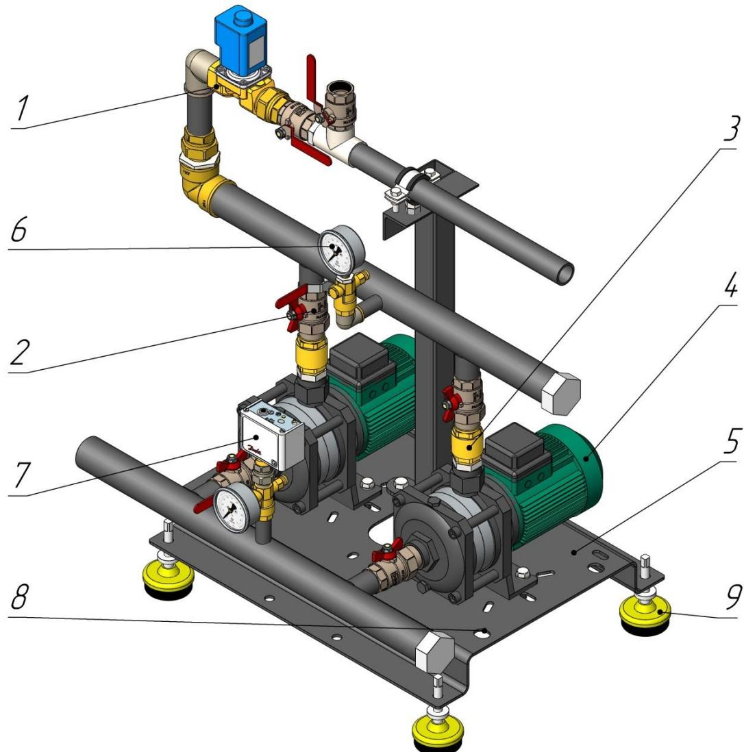
Рисунок – 53. Основное оборудование БТП-62: 1 – клапан соленоидный, 2 – запорная арматура, 3 – клапан обратный, 4 – насос, 5 – рама блока, 6 – манометр, 7 – реле давления, 8 – строповое отверстие.
