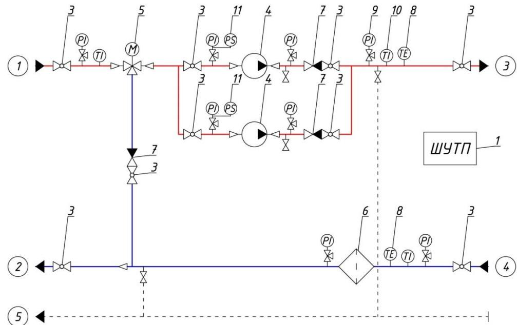
Рисунок – 40. Принципиальная схема БТП-32
