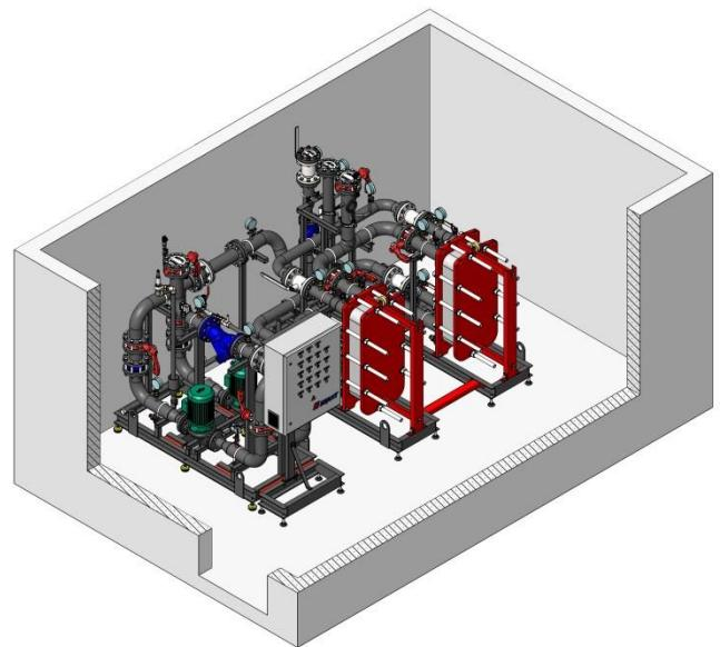
а) блок теплоснабжения с двумя теплообменниками и отдельным гидромодулем
