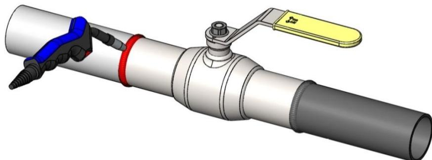
Рисунок – 20. Приварка шарового крана на горизонтальном трубопроводе
