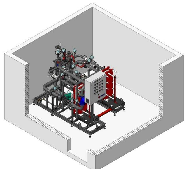
б) блок теплоснабжения с двумя теплообменниками
