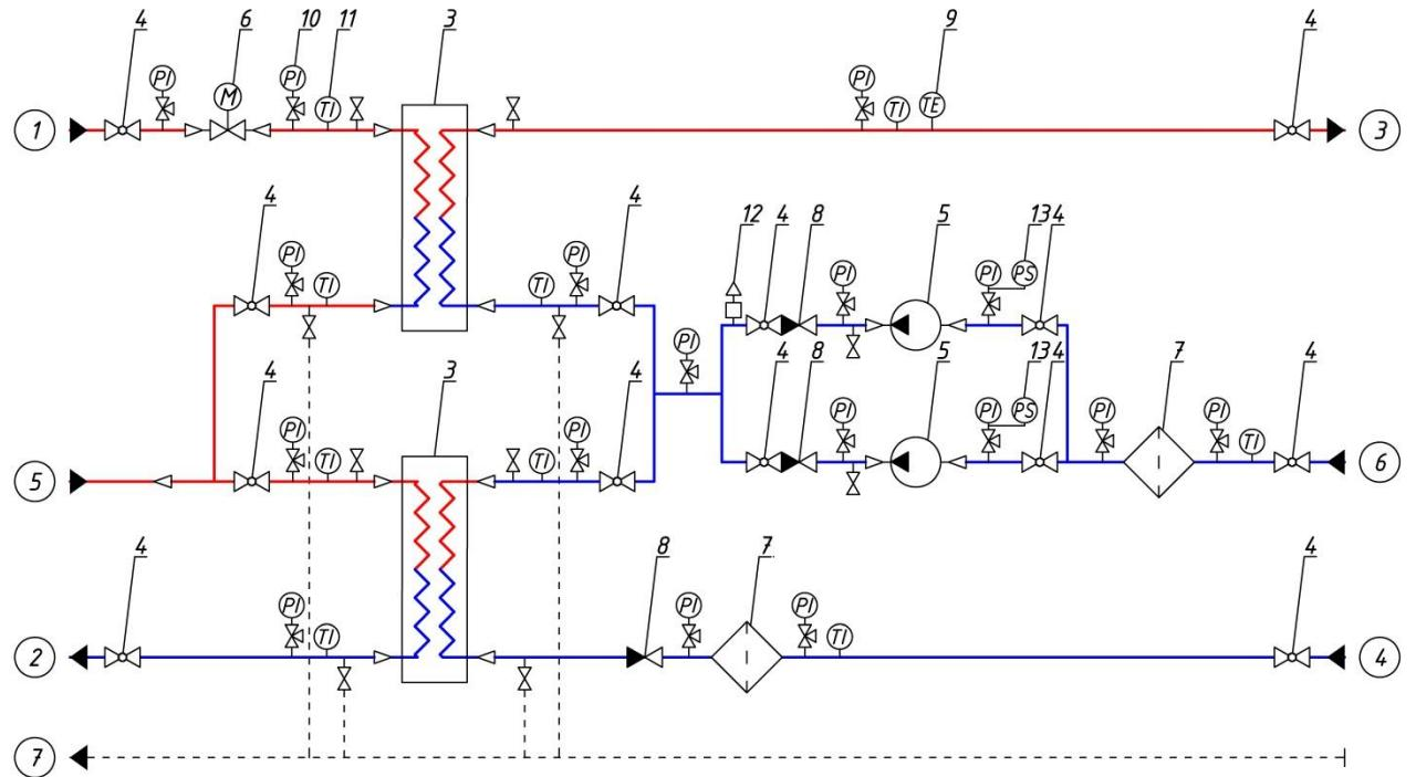
Рисунок – 48. Принципиальная схема БТП-52
