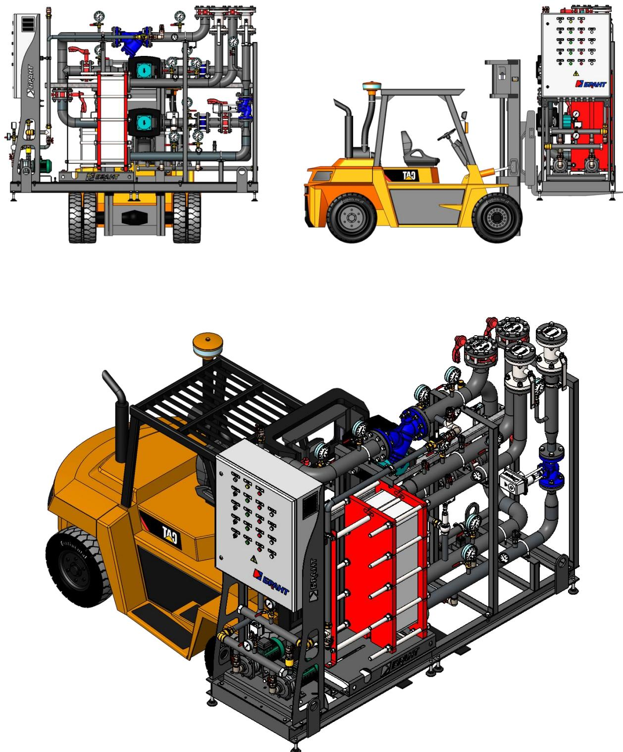
Рисунок – 7. Схема транспортировки блока с помощью вилочного погрузчика
