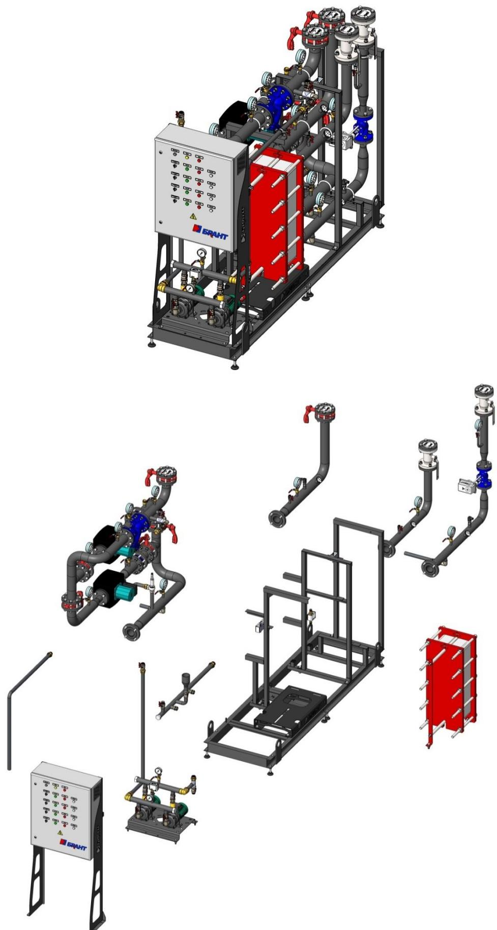
Рисунок – 9. Разборка блока по паям
