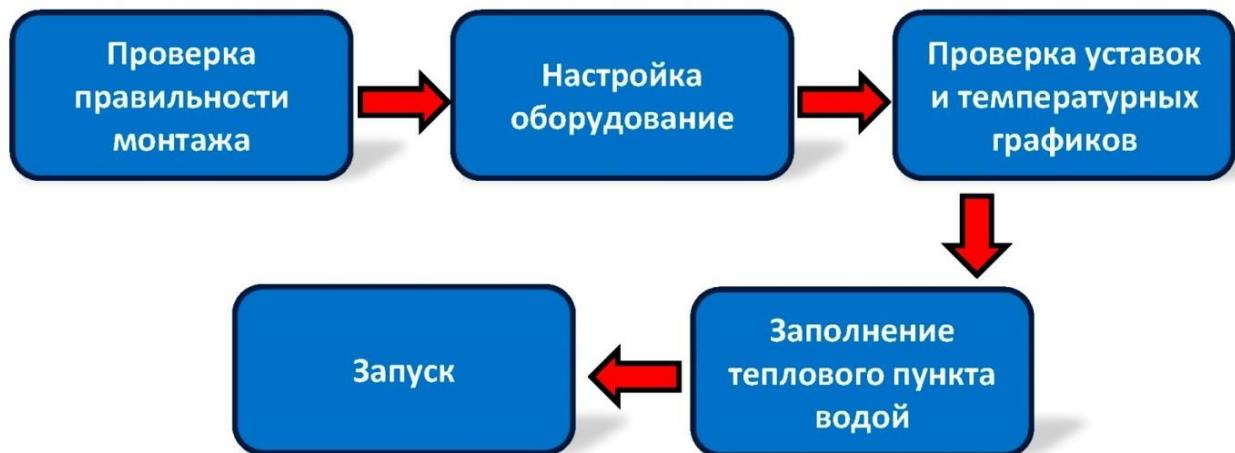
Рисунок – 24. Блок-схема подготовки и запуска БТП
