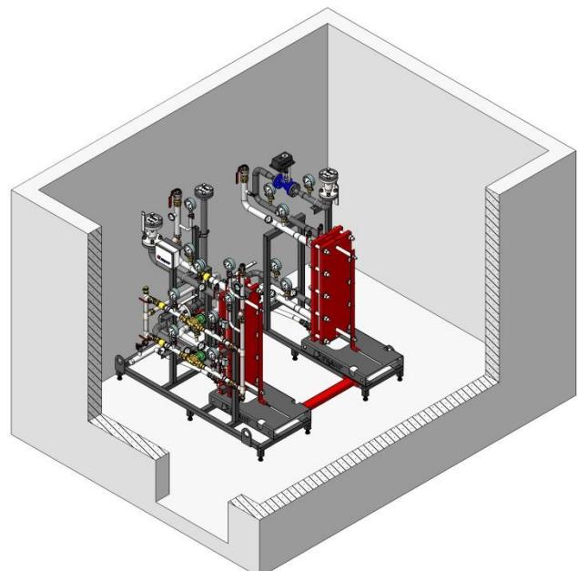
б) блок горячего водоснабжения с двумя теплообменниками
