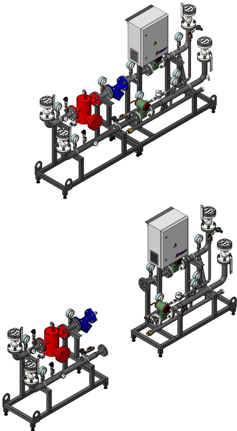
Рисунок – 10. Разборка блока делением на две части
