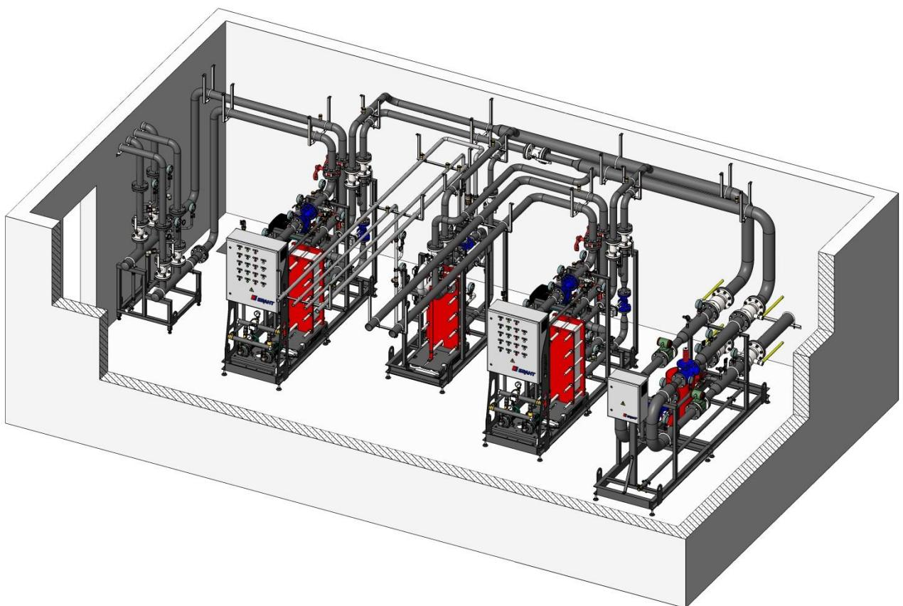
Рисунок – 23. Пример подключения БТП к сетям
