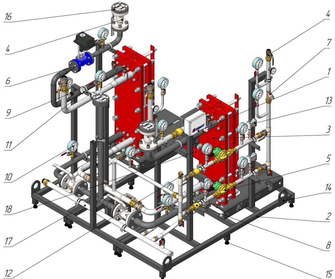
Рисунок – 49. Основное оборудование БТП-52: 1 – клеммная коробка, 2 – рама блока, 3 – теплообменник, 4 – запорная арматура, 5 – насос, 6 – клапан регулирующий, 7 – фильтр сетчатый, 8 – клапан обратный, 9 – термопреобразователь, 10 – манометр, 11 – термометр, 12 – воздухоотводчик, 13 – реле давления, 14 – строповочная проушина, 15 – регулируемая опора, 16 – ответный фланец, 17 – дренажный коллектор, 18 – монтажная вставка.
