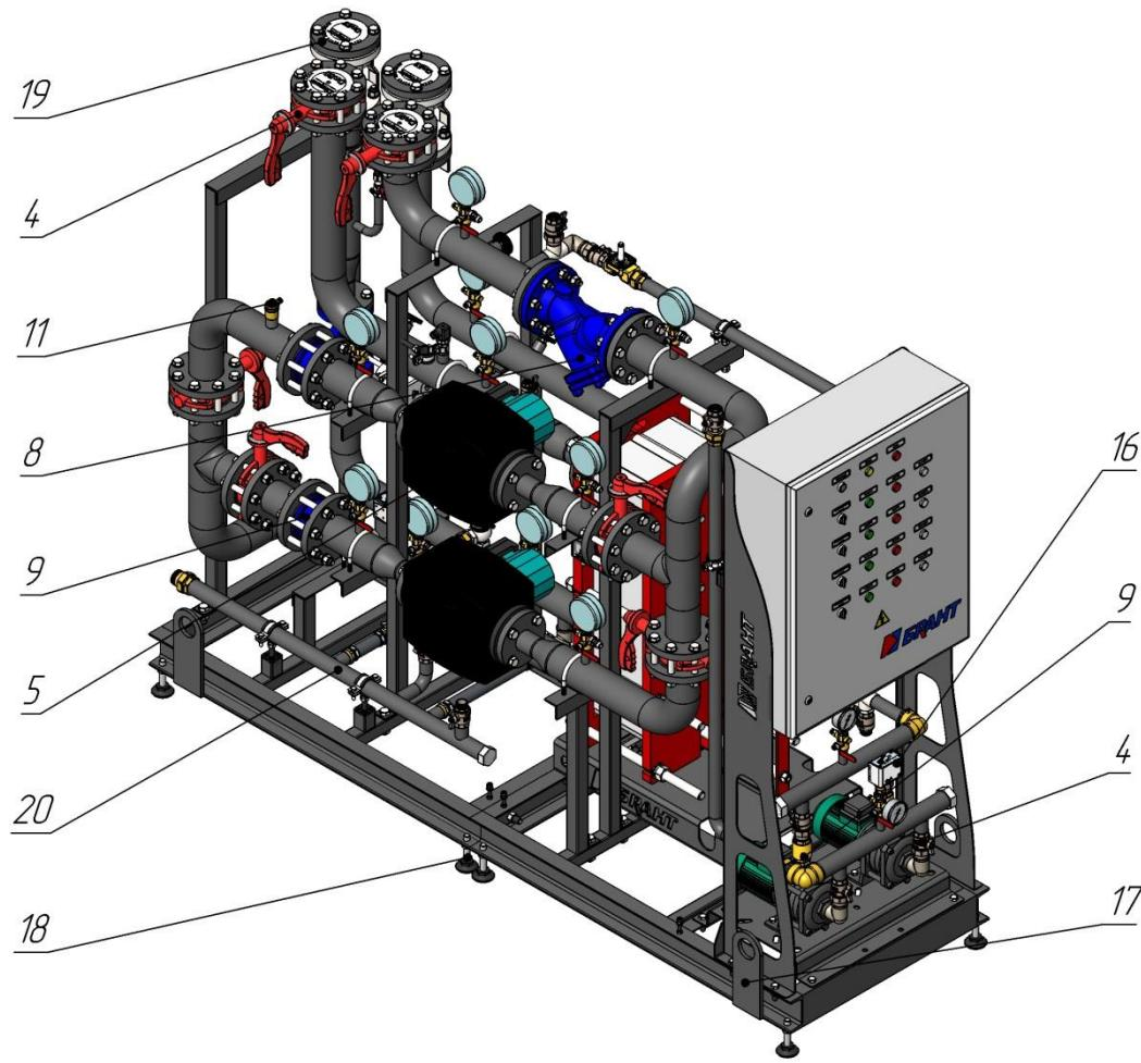
Рисунок – 35. Основное оборудование БТП-21: 1 – шкаф управления, 2 – рама блока, 3 – теплообменник пластинчатый, 4 – запорная арматура, 5 – насос, 6 – клапан регулирующий, 7 – клапан соленоидный, 8 – фильтр, 9 – клапан обратный, 10 – насос подпитки, 11 – воздухоотводчик, 12 – термопреобразователь, 13 – клапан предохранительный, 14 – манометр, 15 – термометр, 16 – реле давления, 17 – строповочная проушина, 18 – регулируемая опора, 19 – ответный фланец, 20 – дренажный коллектор.
