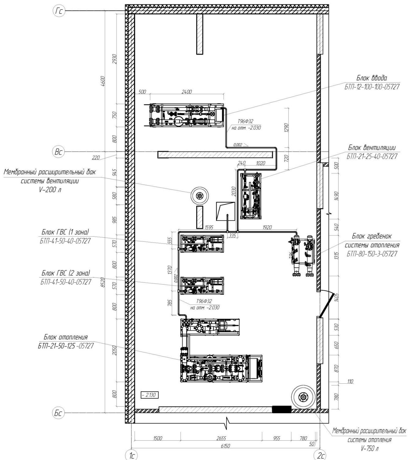
Рисунок – 11. Проектный план расстановки блоков
