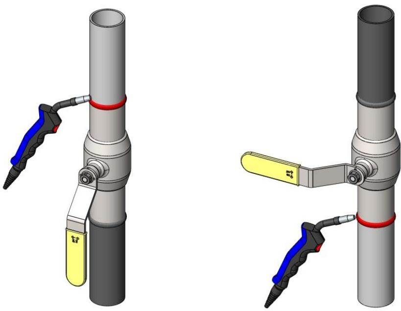
Рисунок – 21. Приварка шарового крана на вертикальном трубопроводе
