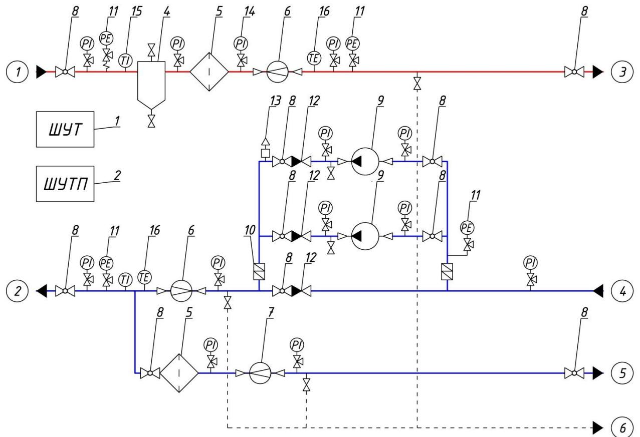
Рисунок – 32. Принципиальная схема БТП-13
