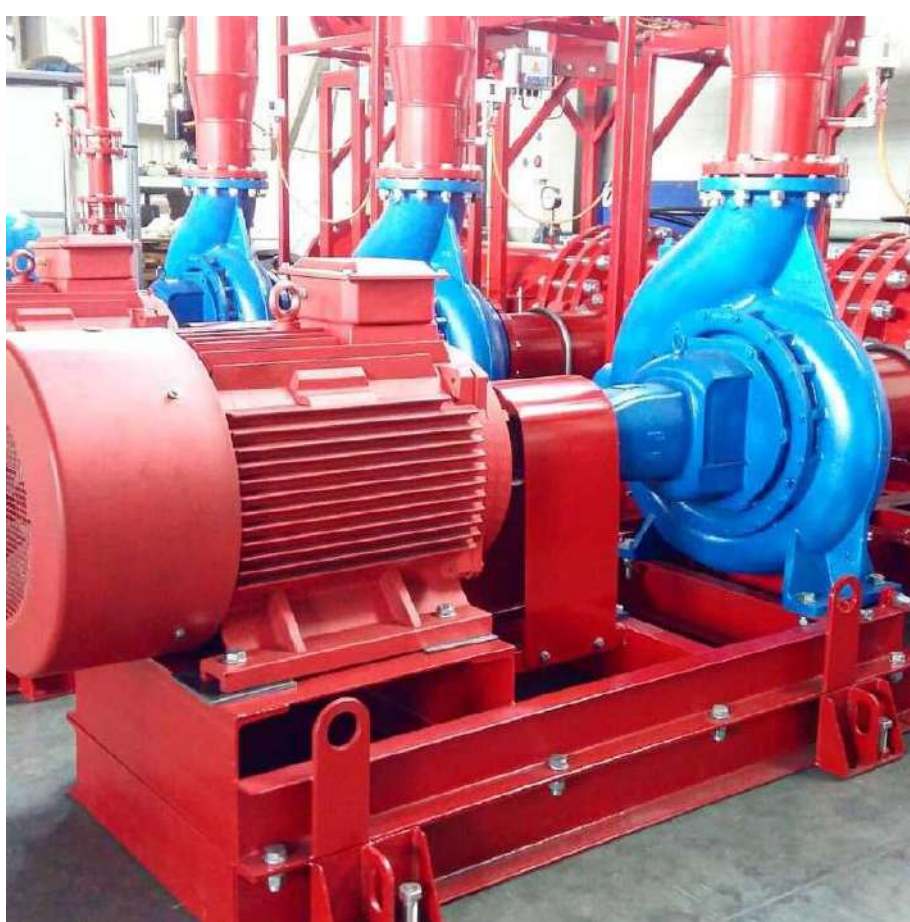
Рисунок – 12. Процесс юстировки консольных насосов
