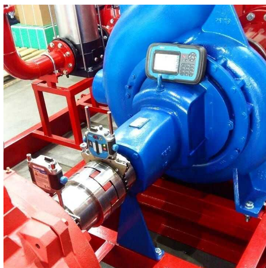
Рисунок – 12. Процесс юстировки консольных насосов
